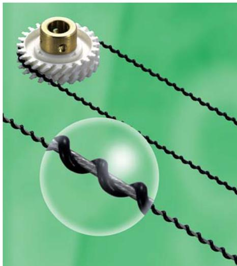
シンクロメッシュロープは、コーティングロープの製造技術と撚り線技術を融合させて生産されたロープです。ワイヤーロープの利便性（3次元取り回し可能）とタイミングベルトの利便性（取り付けが容易）を合わせ持つ製品で、タイミングベルトと同じく専用ギヤによる噛み合い伝達タイプのワイヤーロープです。
